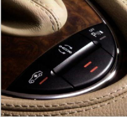
Normalniveau eingestellt. Ein Anheben des Fahrzeugniveaus führt durch Erhöhung des Schwerpunktes zu einer Verschlechterung der Fahreigenschaften und sollte daher nur in fahrdynamisch wenig anspruchsvollen Fahrsituationen erfolgen.
