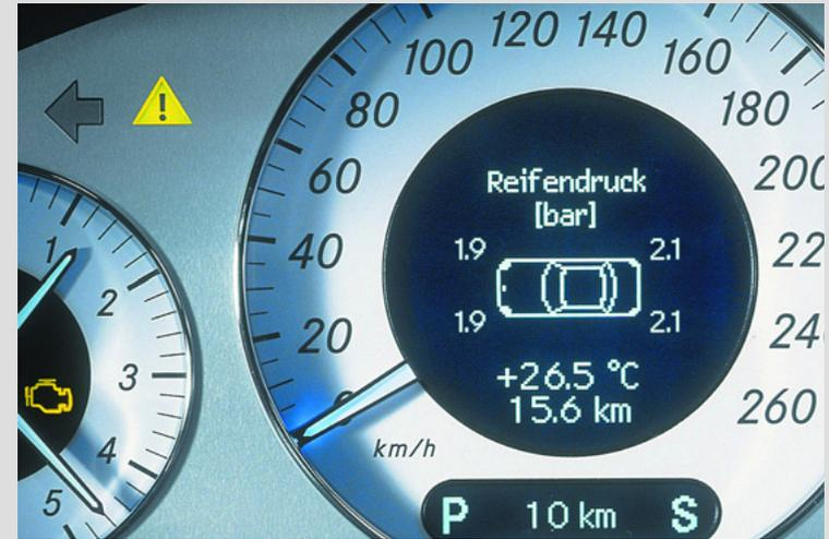
Reifendruckverlust-Warnung und RDK können nicht bei plötzlichem Druckverlust warnen, den beispielsweise ein eingedrungener Fremdkörper ausgelöst hat. Beide Systeme ersetzen auch nicht die regelmäßige Reifenkontrolle, bei der stets die Reifen auch auf Beschädigung und Verschleiß sowie das ggf. vorhandene Reserverad überprüft werden sollten.
